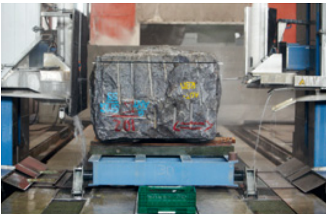
Bei Gräf wird mit modernen Maschinen gearbeitet. Hier ist eine Blockseilsäge von Burkhardt-Hensel zu sehen.
