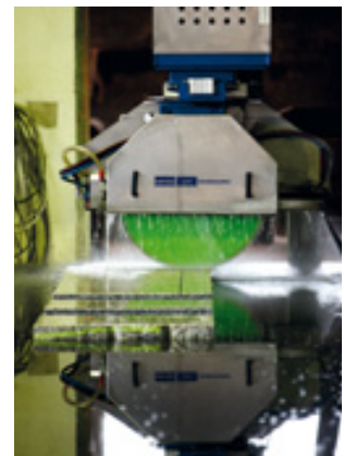
Die richtigen Maße erhalten Platten und Einfassungen mithilfe von Brückensägen.
