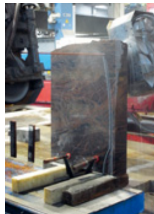
Konturenseilsägen (SFT) übernehmen die Formgebung der Oberteile. Foto: Lisa Tauer
